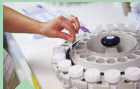
Toestel waarin het dunnelaagpreparaat wordt gemaakt: de cellen worden homogeen in de oplossing verdeeld en daarna gefilterd. Van dit filtertje wordt een afdruk op een glaasje gemaakt
